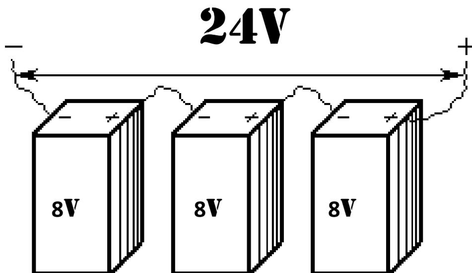
*Рис.3. Пример последовательного соединения элементов для получения 24В из 8В элементов*
