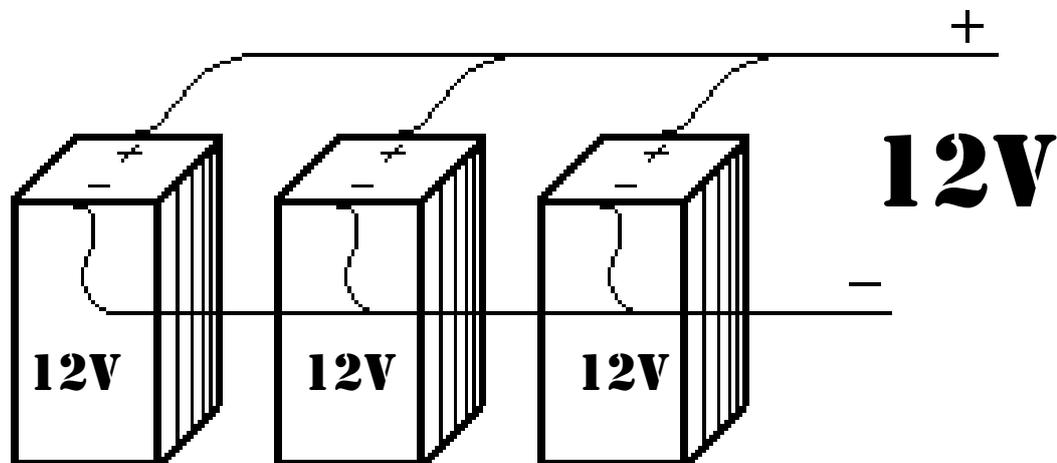
*Рис.2. Пример параллельного соединения нескольких 12В батарей для получения 12В*
