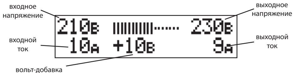
Рисунок 7. Вид ЖК-индикатора в режиме изменения выходного напряжения
