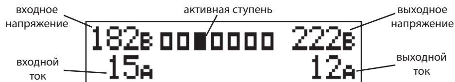
Рисунок 6. Вид ЖК-индикатора в режиме ступенчатого регулирования
