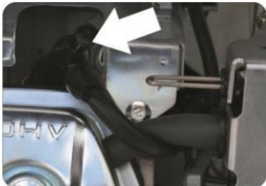
Свеча зажигания: эквивалент TORCH F6TC.
