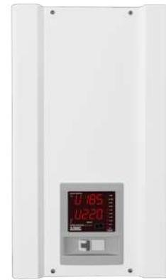
Однофазный стабилизатор напряжения Ампер 9 предназначен для работы в электрических сетях с колебаниями напряжения от 160 до 260В. В этом диапазоне аппарат выдает на выходе напряжение в рамках  $220V \pm 4.5\%$ , что обеспечивается за счет использования 9 ступеней стабилизации.
