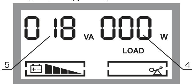
4. Индикация нагрузки подключенной к ИБП в Вт.
