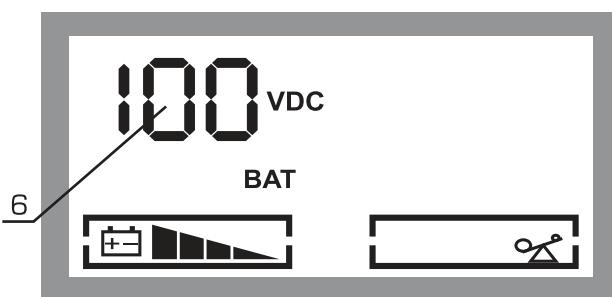
6. Индикация напряжения аккумуляторных батарей.
