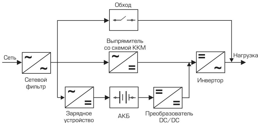
Рис. 3. Структурная схема ИБП.
