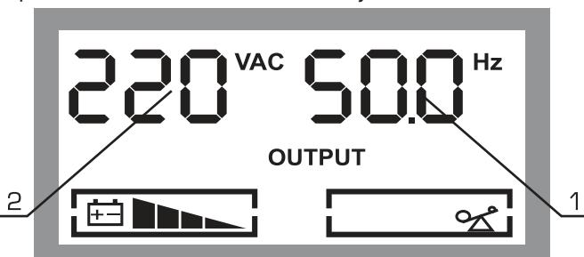
1. Индикация частоты выходного напряжения
