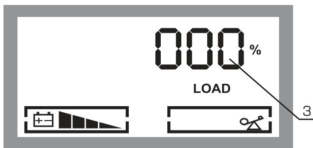
3. Индикация нагрузки подключенной к ИБП в %.
