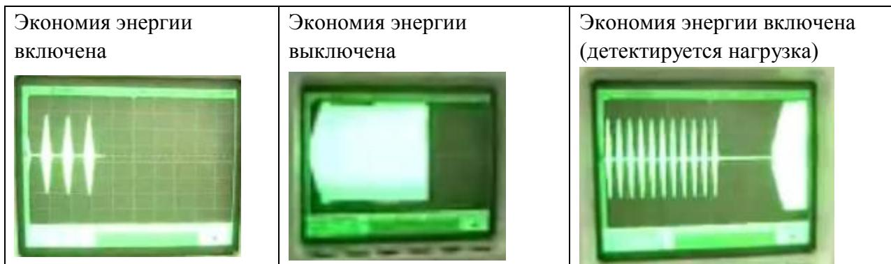
**Примечание: минимальная мощность нагрузки, которая выводит ИБП из «спящего» режима (Power Saver On) – 25 Вт.**
