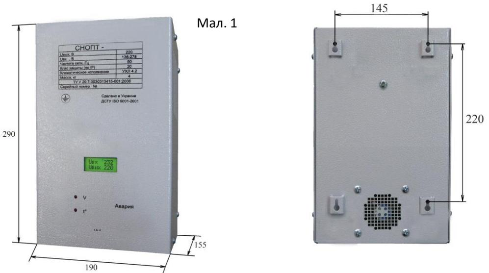
Підключіть до стабілізатора вилку електроспоживачів потім підключіть вилку стабілізатора до електромережі. Увімкніть тумблер, після самодіагностики рідкокристалічний індикатор почне відображати вхідна й вихідна напруга.
